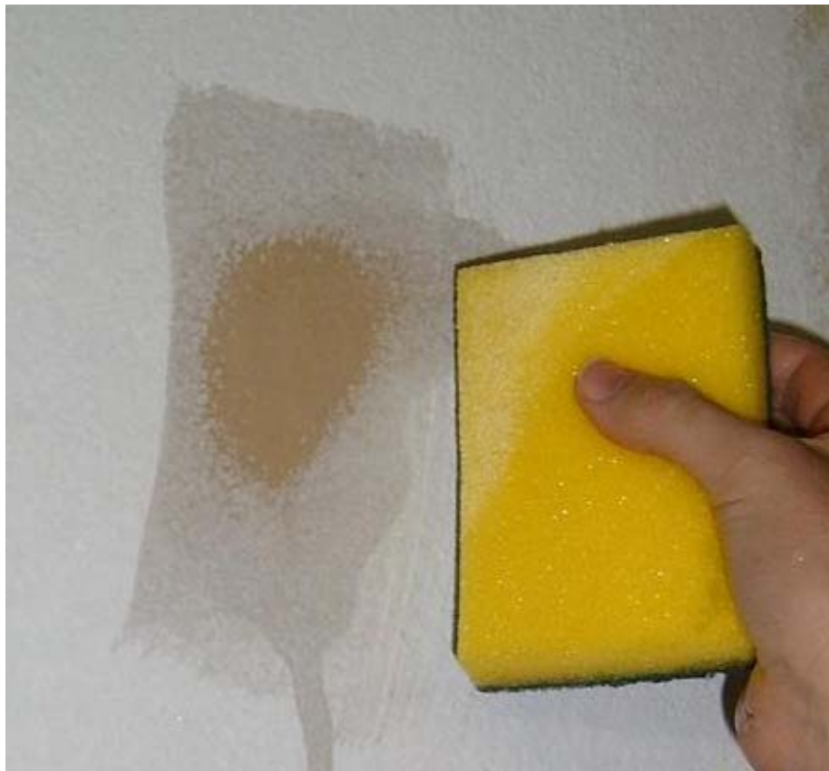
Fig. 3: Tinta com baixa resistência à abrasão. A durabilidade do produto está comprometida, pois não resiste a procedimentos simples de limpeza.
