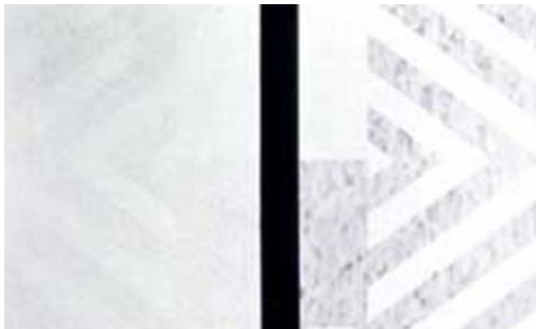
Fig. 2: Tinta com baixo poder de cobertura seca. No lado direito, fica evidente a pouca capacidade de cobrir o desenho original da parede.
