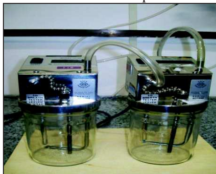
Figura 3 – Dois simuladores de sopro conectados em série
